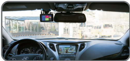
전방 카메라 설치 후 사진
