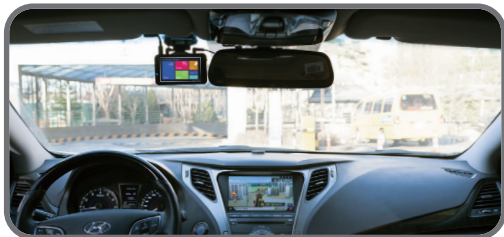
전방 카메라 설치 후 사진
