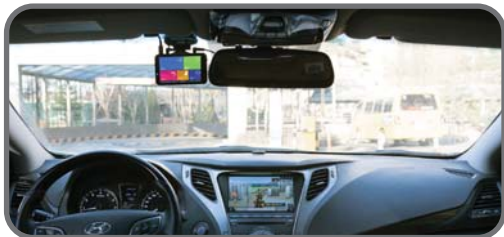
전방 카메라 설치 후 사진
