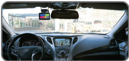
전방카메라 설치 후 사진
