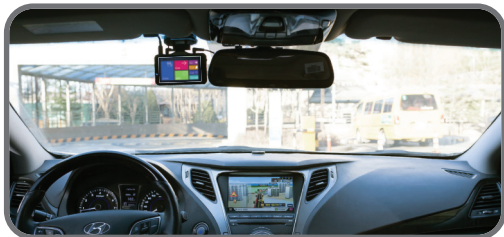
전방 카메라 설치 후 사진
